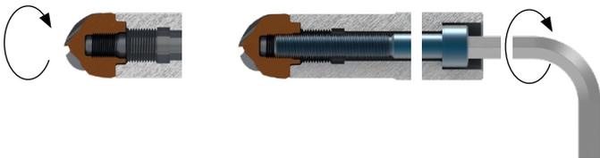
1. Wechselkopfeinsatz linear auf Plananlage des Halters einsetzen und leicht im Uhrzeigersinn drehen, bis dieser klemmt.
