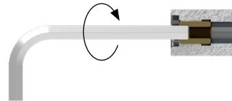
3. Gewindebuchse wieder in Halter montieren, bis diese am Grund anliegt. Nur handfest anziehen.
