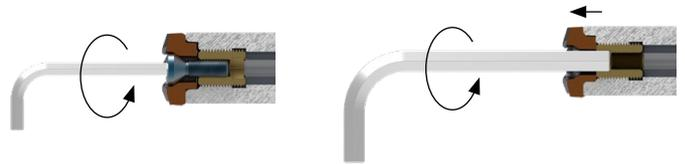
1. Klemmschraube lösen und entfernen.
