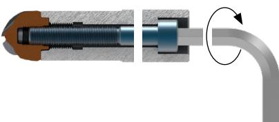
2. Stegnite vijak kroz držač na specifični moment (3,5 Nm / 5,0 Nm).
